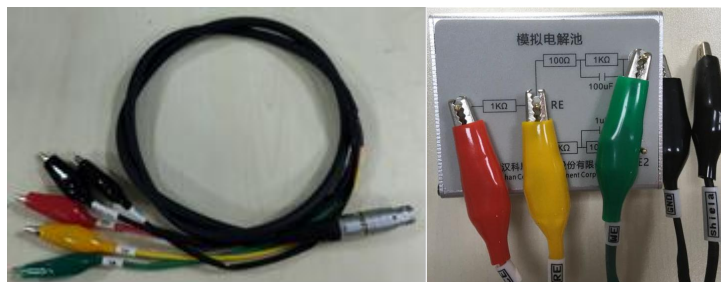
图 3.2 不含 SEN 电极夹时电极电缆线连接方法
