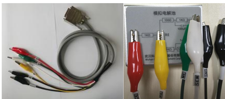
图 3.3 含有 SEN 电极夹时电极电缆线连接方法
