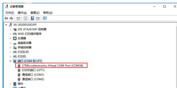
图 1.3 USB 驱动正确安装后设备管理器端口
